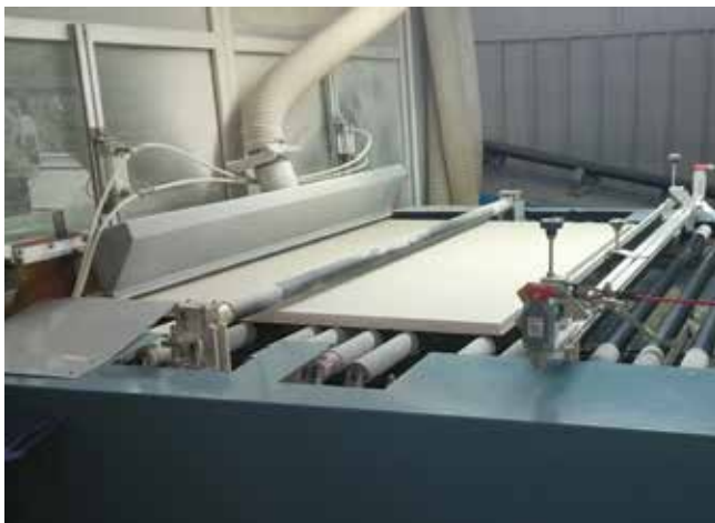
Entlang der Fliesenstraße werden die Platten nach dem Brennvorgang auf Format geschnitten
