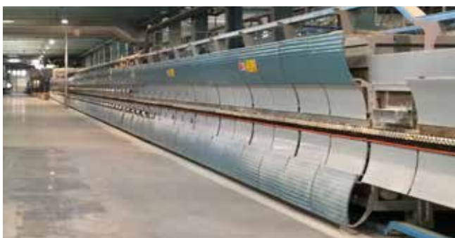
In bis zu 160 Metern langen Brennöfen werden ausgewählte Rohstoffe bei einer Temperatur bis 1.200 °C verarbeitet.
