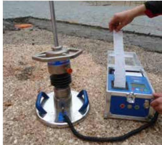
Dynamisches Lastplattenprüfgerät mit Auswertungssystem inkl. GPS Daten.
