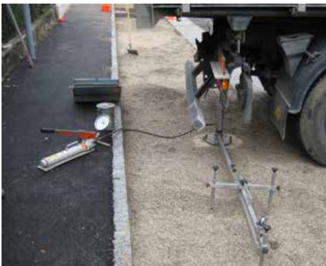
Statisches Lastplattenprüfgerät mit einem LKW als Gegengewicht.
