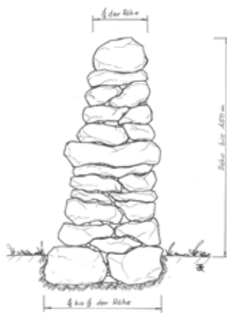
Freistehende Trockenmauer - Statische Grundsätze
